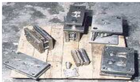
Moldes para cortar y copar la hojalata litografiada.
